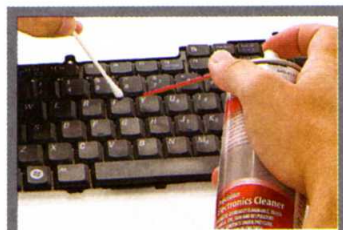
Промокните жидкость тампоном и продуйте устройство сжатым воздухом
